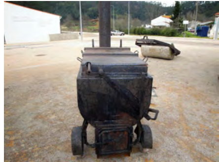
Máquina de alcatroar e rolo compressor
