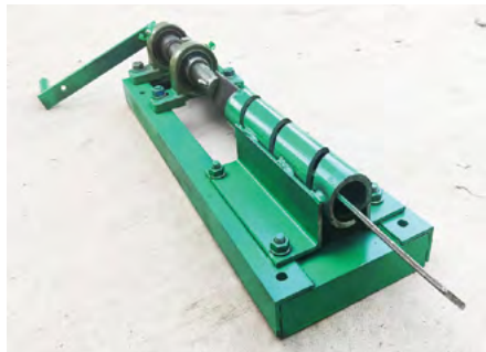
Maquineta de transformar arame em rede
